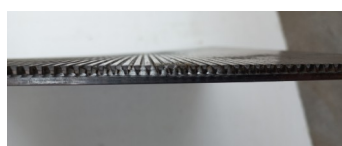
(photo 10 : Exemple d'une boîte d'entrée de turbine TRG avec un tuyau de sortie frontal (non recommandé). La maille est en coanda et permet de capter environ 15-18 L/s par boîte).
