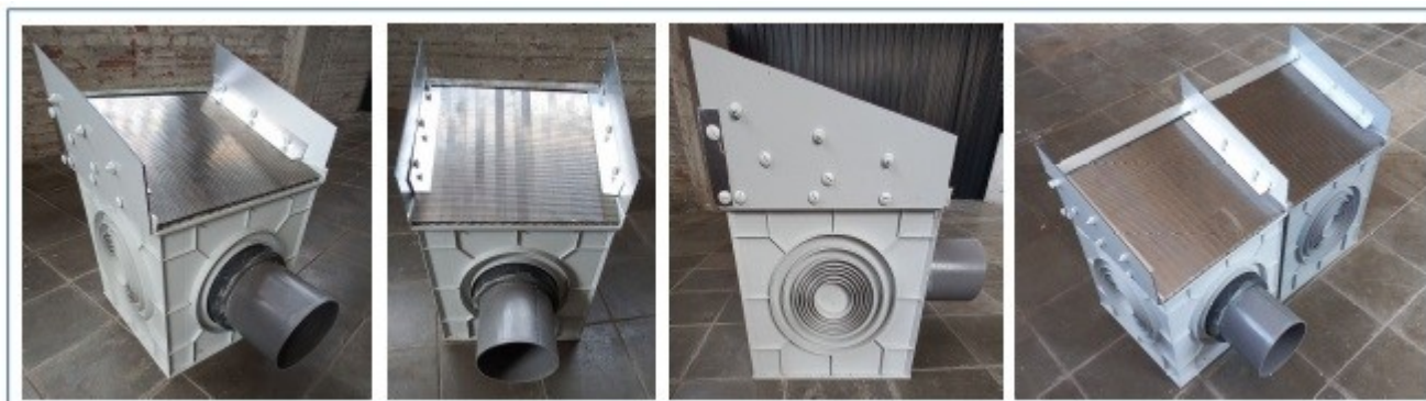
(photo 10 : Exemple d'une boîte d'entrée de turbine TRG avec un tuyau de sortie frontal (non recommandé). La maille est en coanda et permet de capter environ 15-18 L/s par boîte).
